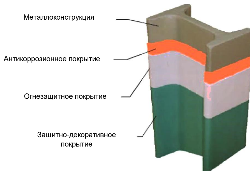
Рисунок Д.1 — Двутавровая балка с нанесением антикоррозионных, огнезащитных и защитно-декоративных покрытий
